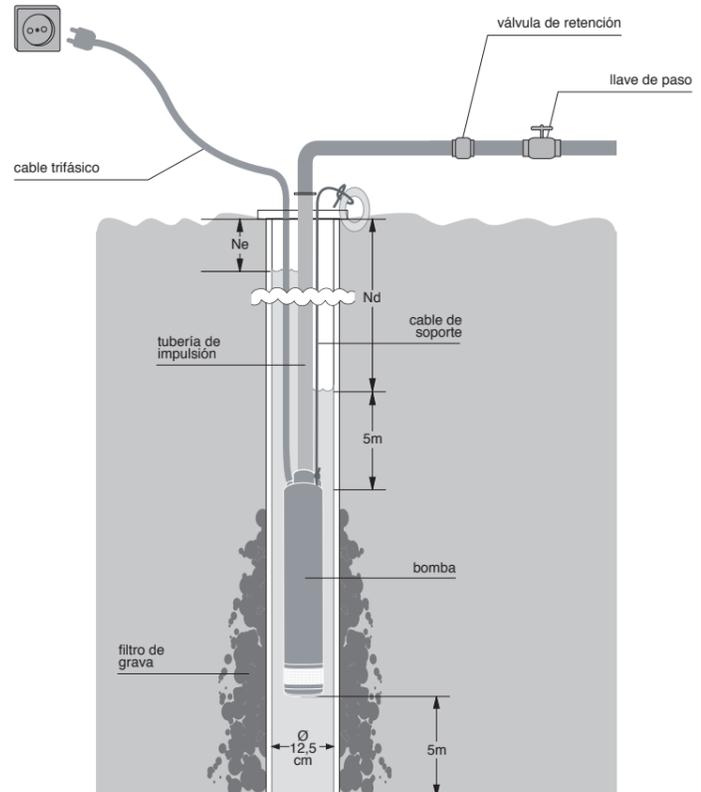
Esta bomba puede instalarse de forma estacionaria con una tubería rígida o con un tubo flexible.
