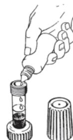
Apretar el émbolo lentamente hasta que toque la mezcla, colocar la tapa y atornillar lentamente hasta que se vea la solución filtrada dentro del émbolo.
